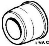
18G 123 AJ. Bussola guida per alesatura cuscinetto posteriore albero a camme
