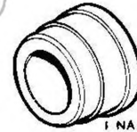
18G 123 BB Bussola guida per alesatura cuscinetto posteriore albero a camme
