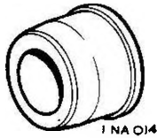
18G 123 AH. Bussola guida per alesatura cuscinetto centrale albero a camme
