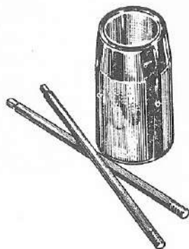
Fig. 3 - Attrezzo a boccola 2361/J per montaggio dell'anello paraolio albero motore, lato frizione
