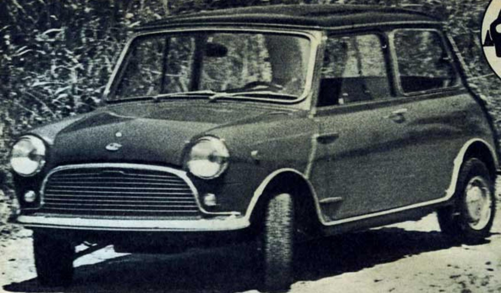
E' DIVERSA - Esteriormente la Cooper Innocenti non differisce dalla Mini 850 che per alcuni particolari di dettaglio quali le ruote con cerchi di sezione maggiore e la scritta posteriore; la verniciatura è bicolore
